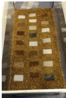
Figure : Enfouissement en laboratoire
